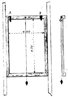
pelo fio a prumo que permitirá, em seguido, avaliar em decímetros os afastamentos horizontais.
